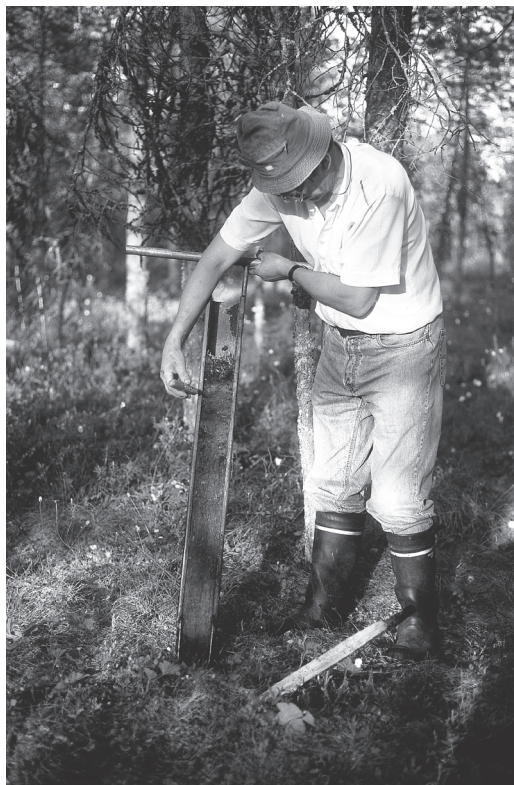
Kuva 2. Kirjoittaja esittelee turvenäytettä laatikkokairassa (malli Jeglum) Oriveden Lakkasuolla kesällä 1992. Hiilikerrosta, joka voitiin tarkasti ajoittaa, seurattiin useissa kairauspisteissä sekä luonnontilaisella että sen ojitetulla osalla ja tuloksia käytettiin turpeen viimeaikaisen (näennäisen) hiilikertymän nopeuden määrittämiseen. Kuvannut Harri Vasander.
