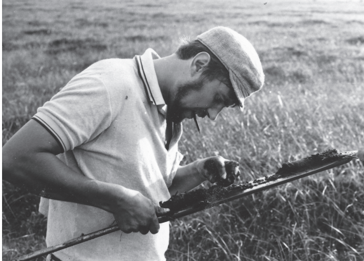
Kuva 1. Kirjoittaja pienen venäläisen kairan kanssa Jyllannin Draved Mose –suolla v. 1970. Kairan kärkiosa on huomattavasti lyhyempi ja siipi (laippa) kapeampi kuin prototyypissä. Kuva: Pekka Pakarinen.
